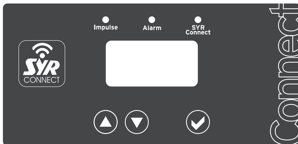
Fig. 12: Panel de control con pantalla, LED y botones de mando
