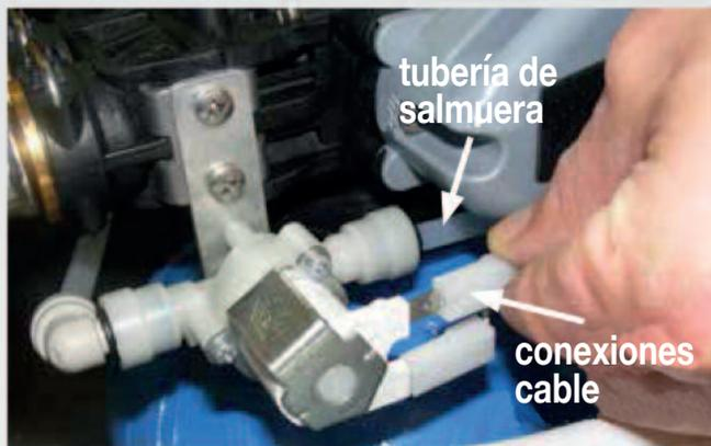
6. Conecte la tubería de salmuera y las conexiones de cable con la válvula electromagnética.
