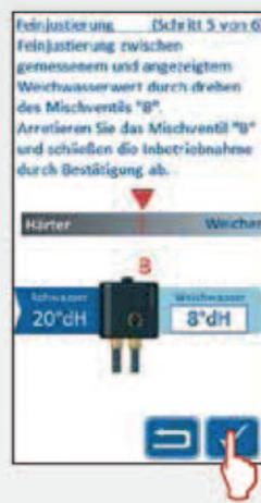
10. Compruebe la dureza del agua con la ayuda del kit de medición de dureza en una toma cualquiera y, si es necesario, regule mediante la válvula de mezcla "B" hasta obtener la dureza deseada.
