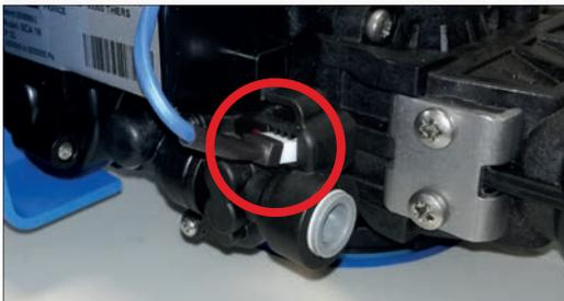
Stecken Sie das Verbindungskabel in den Chlorgenerator.
