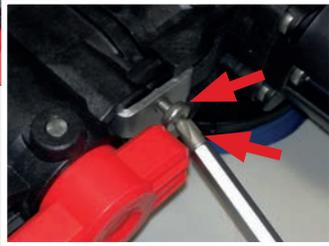
Schrauben Sie mit den vier Schrauben die beiden Halteklammern wieder fest.
