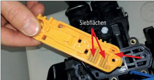
Entnehmen Sie die Halterung und reinigen Sie besonders die Siebflächen mit kaltem klarem Wasser.
