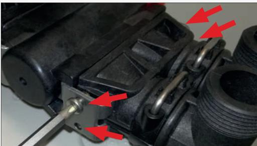
Schrauben Sie anschließend die beiden Halteklammern mit den vier Schrauben fest.
