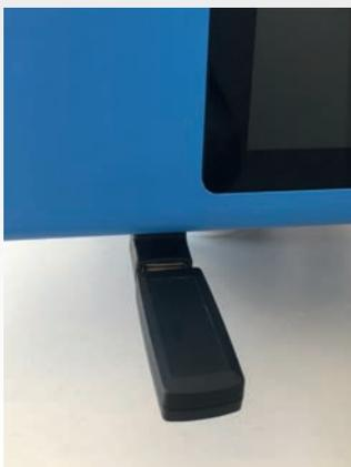
Stecken Sie den Wlan-Stick mit dem Winkeladapter an der Unterseite des Controllers.
