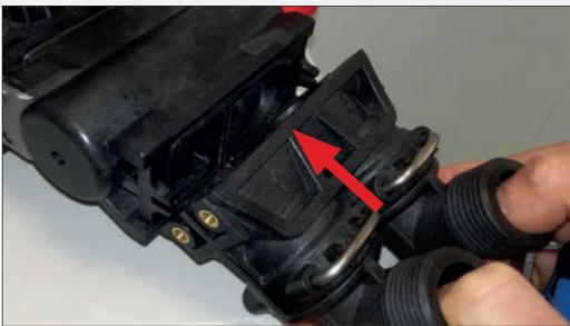
Setzen Sie nun den zuvor demontierten Anschlussblock auf den Block mit dem Umgehungsventil.
